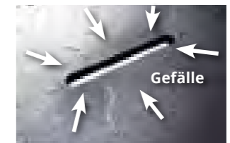
Flüssigkeitsableitung zum Schlitz aus allen Richtungen
